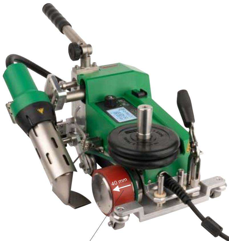
Banda de soldadura de 40 mm.
